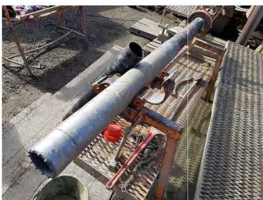
Doppelkernrohr mit PE-Inliner DN100
