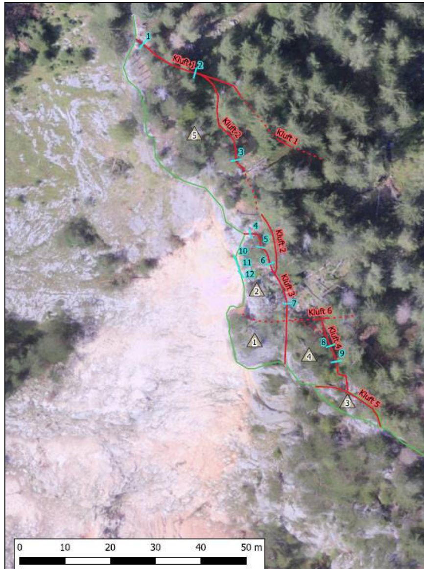
Abb. 6: Lage der Fissurometer 1 - 9 oberhalb der Pürggerwand im Bereich der Zerrklüfte.
