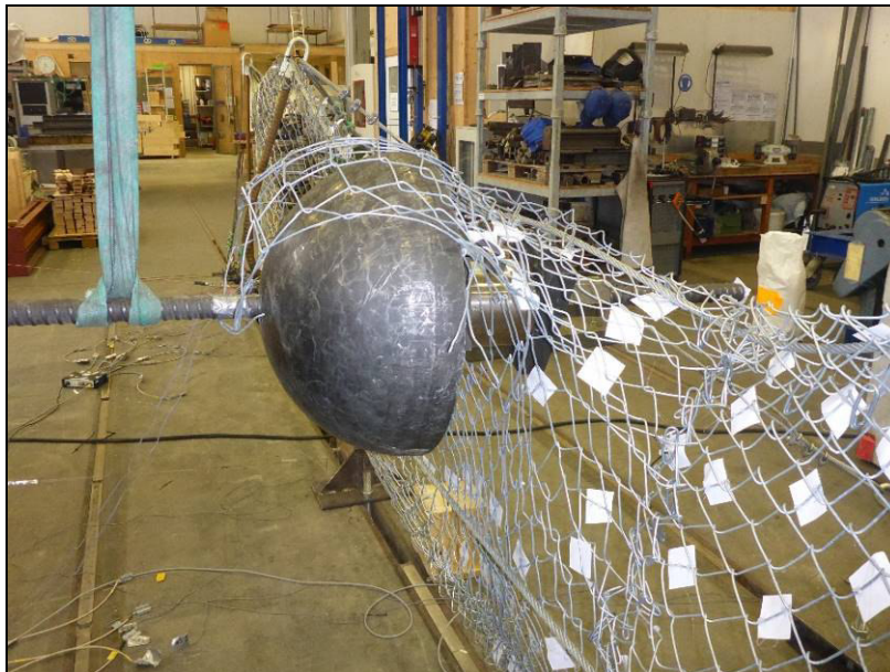
Abb. 5: Belasteter Zaun aus dem Laborversuch
